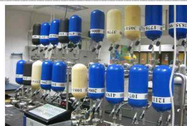
공기포집 및 보관을 위한 플라스크와 보관소(NOAA 지구시스템연구실)
