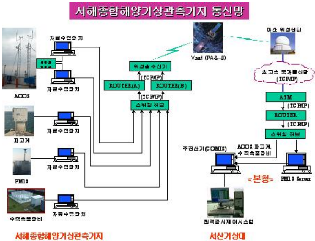
[그림 3-9] 서해종합해양기상관측기지 관측장비 및 통신망 개통도
