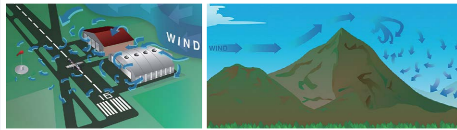
[그림 8] 인공장애물(좌)과 자연장애물(우)로 인한 난류 흐름(Pilot handbook of aeronautical knowledge)
