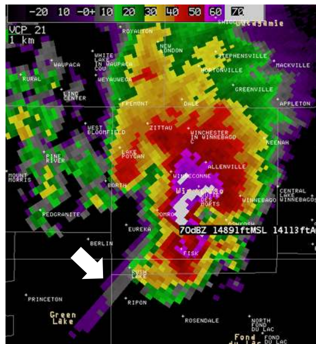
[그림 1.172] 고도각 2.4°에서 관측한 삼체산란 스파이크의 예시
