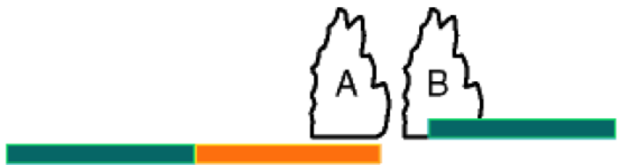
[그림 1.20] 이 그림은 관측 가능한 최대 거리 분해능의 예임. 두 물체는 적어도 펄스 길이의 1/2일 때 분리되어질 수 있음. 위쪽의 녹색 막대기는 송신펄스, 아래쪽의 녹색과 오렌지색 막대기는 목표물 A와 B에 의한 수신신호
