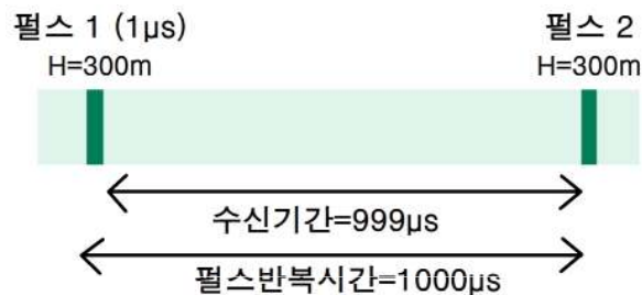
[그림 1.5] 펄스지속시간, t 와 수신시간, \tau . x 축은 시간, 그리고 빛의 속도, c 를 곱하면, 물리적인 펄스 폭, H 가 됨
