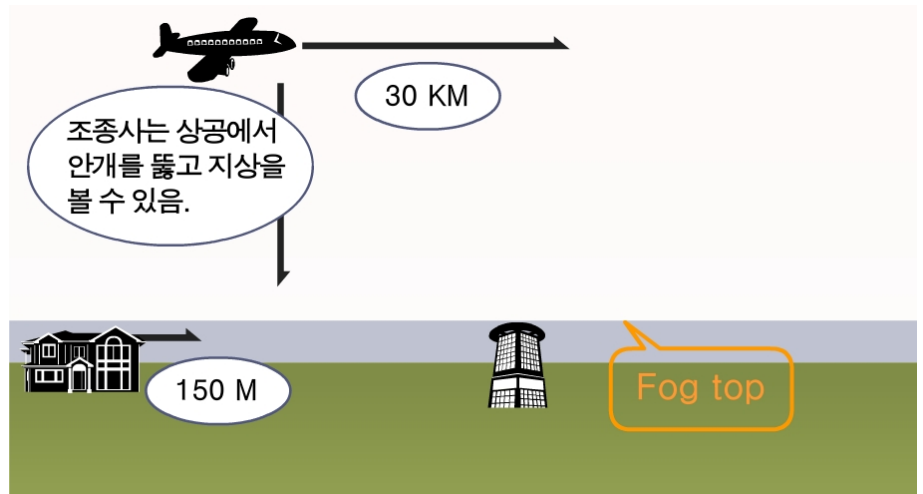
[그림 1.41] 조종사가 안개층 위를 비행하는 상황. 조종사는 지상의 구조물들을 깨끗하게 확인할 수 있을 것이다. 그러나 지표면에 접근해서 안개층 안으로 들어가면 시정이 급격하게 떨어지는 것을 경험할 것이다.
