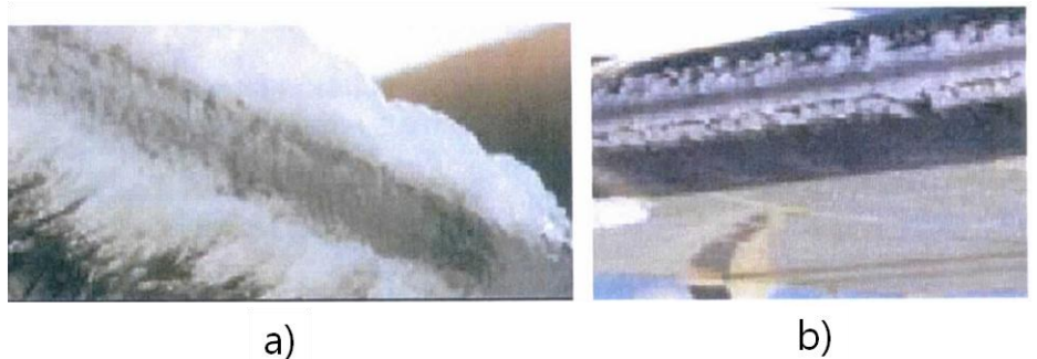
[그림 1.25] 착빙의 예(계속) a) 맑고/반짝이는 착빙이 항공기 전면에 형성, b) 혼합 착빙이 항공기 날개 전면에 형성
